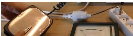
Figure 3 : Exemple d'une partie appliquée d'un défibrillateur
